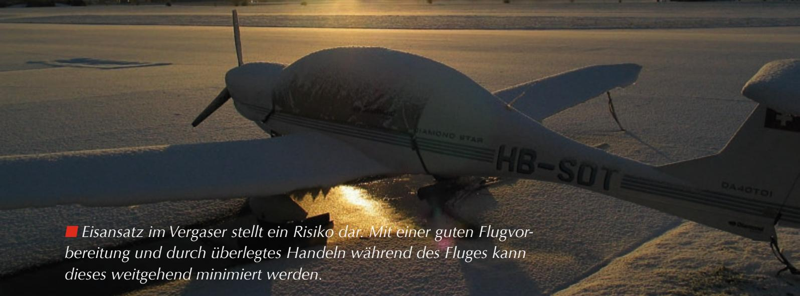
■ Eisansatz im Vergaser stellt ein Risiko dar. Mit einer guten Flugvorbereitung und durch überlegtes Handeln während des Fluges kann dieses weitgehend minimiert werden.
